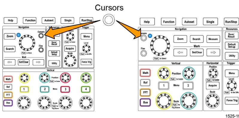
光标颜色指示进行测量的通道。
