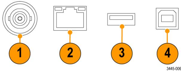
3. **USB 2.0 主机端口**。标准 USB 主机端口可让您以无线连接方式（Tektronix TBS2000B 系列独有功能）连接 USB Wi-Fi 收发器适配器（加密狗），或者连接至 U 盘，以保存或调出波形、设置、屏幕图像和课件教学包。
