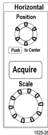
按 **Position** (位置) 旋钮, 将触发点恢复至屏幕中心 (中心垂直刻度线)。
