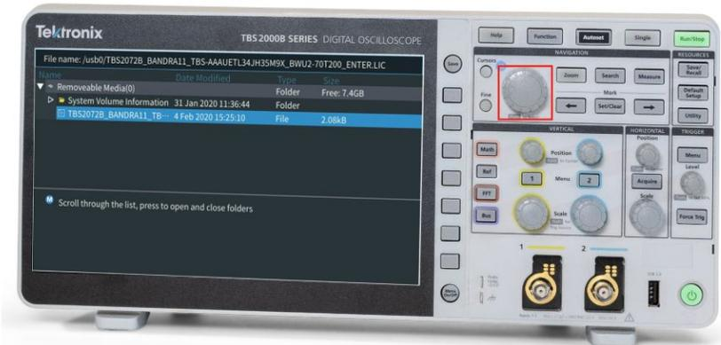
7. 示波器会安装许可证并返回到安装许可证屏幕。关闭示波器的电源并再次打开，以便启用已安装的升级。
