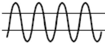
屏幕光标：垂直光标和水平光标的组合。单击 **Multipurpose**（通用）旋钮，以循环浏览选择光标。
