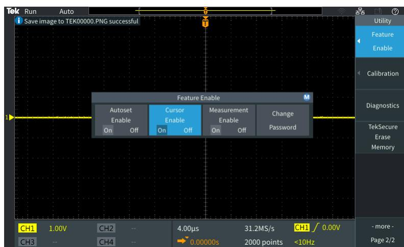
5. 使用 **Multipurpose**（通用）旋钮和侧面菜单按钮输入可让您禁用光标的密码。
