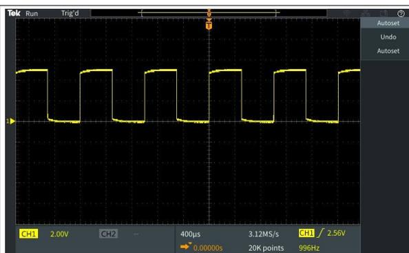
如果显示的方波顶部不平缓，请执行程序以补偿探头高频响应。您可在完成该功能检查后对探头进行补偿。请参阅 [补偿无源电压探头第27 页](#)。
