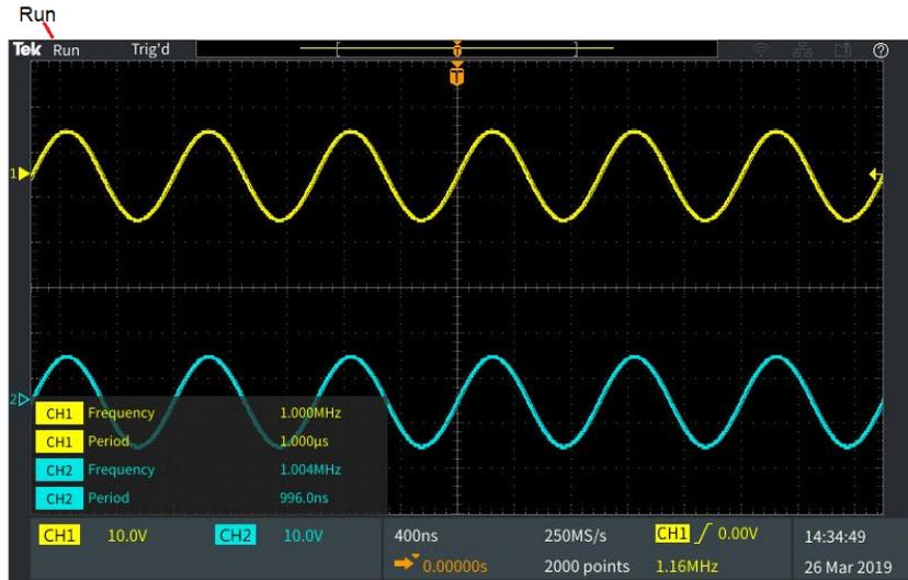
2. **预览**：示波器停止，您已使用 **Horizontal Scale**（水平标度）或 **Vertical Scale**（垂直标度）或 **Position**（位置）旋钮更改设置。在预览模式中，示波器显示采用更改的位置或标度设置的下一次采集可能情况的“预览”，基于上一个采集波形，并假设以新设置采集相同的信号。
