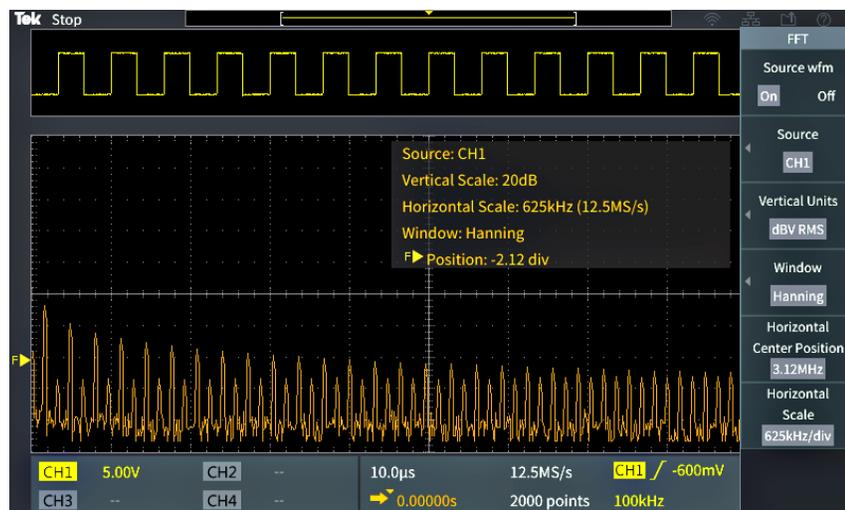
3. 按 **Source wfm**（源波形）侧面菜单按钮，以在 **On**（打开）或 **Off**（关闭）源波形显示（屏幕顶部）之间切换。
