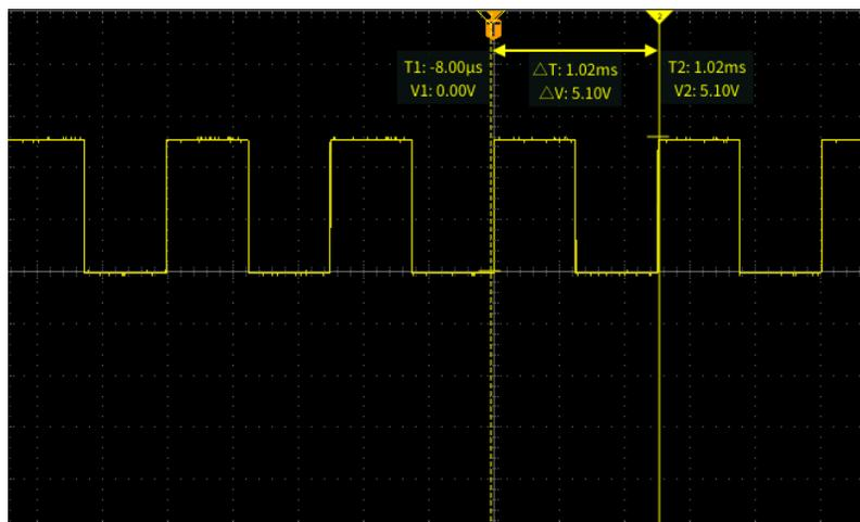
光标读数在光标旁边显示。读数将显示当前光标位置的信号值。读数还会显示两个光标测量之间的差异（增量，以  $\Delta$  符号标记）。打开光标时，示波器始终显示该读数。
