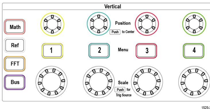
垂直控件可为每个通道设置垂直设置（位置和标度），并打开或关闭单个波形。
