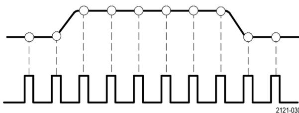
TBS2000B 系列示波器使用实时采样。在实时采样中，示波器一次性、按顺序将所有采样点进行采样并数字化，将采样数据存储在内存在中，然后重复采样和存储过程。
