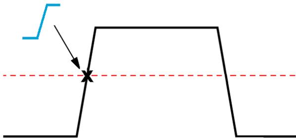
欠幅触发需要两个门限以定义信号必须通过才能被视为有效（非欠幅）信号的两个电平。
