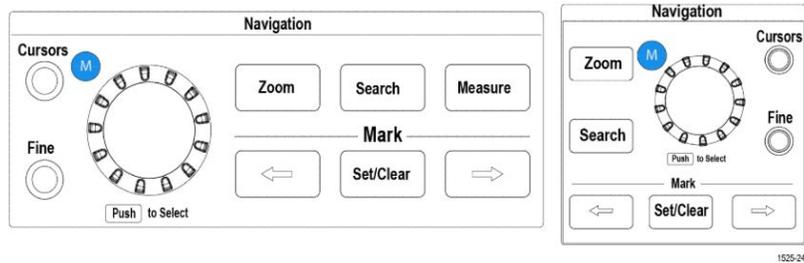
图 3: 在 TBS2000B 上的 2 通道和 4 通道上导航
