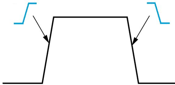
触发门限 **Level**（电平）（或只是电平）为斜率的信号幅度值，必须发生以使示波器触发信号。
