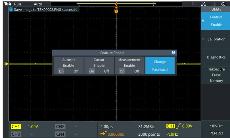
6. 使用 **Multipurpose**（通用）旋钮和侧面菜单按钮以选择字母数字并输入当前密码的字符。然后按 **OK**（确定）侧面菜单按钮。出厂默认密码为 000000。
