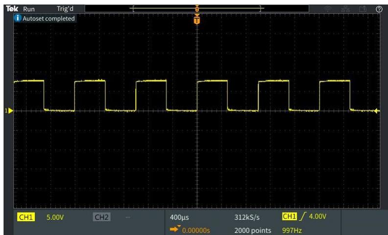
7. 检查显示波形的形状，以确定是否需要调整探头。如果波形有方形上升边沿以及平缓的顶部和底部，则无需调整探头。
