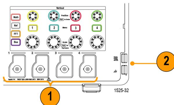
2. **PROBE COMP** (探头补偿)。使用方波信号源和接地连接以补偿探头。
