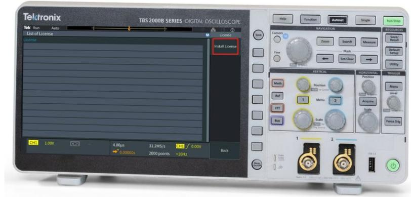
6. 旋转旋钮以导航到文件路径，然后按下旋钮以选择要安装的升级许可证文件。
