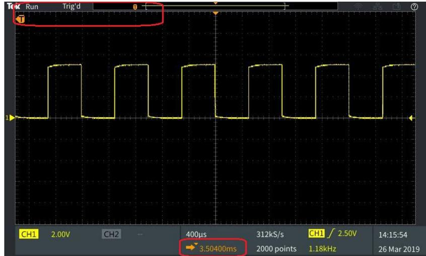
4. 一旦您在屏幕中心显示感兴趣的波形区域, 则调整 **Horizontal Scale** (水平标度) 旋钮以采集该感兴趣区域的更多点, 并使用控件查看更多细节。
