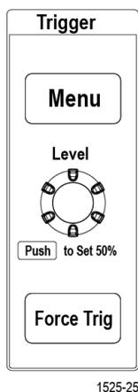
**Trigger Menu**（触发菜单）按钮可打开侧面菜单以进行触发设置。
