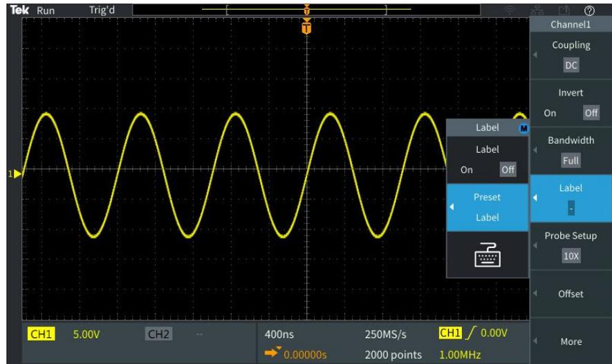
3. 要打开或关闭标签文本，请使用 **Multipurpose**（通用）旋钮选择 **Label ON/OFF**（打开/关闭标签），并在所需选项上单击 **Multipurpose**（通用）旋钮。
