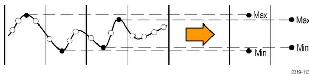
**Hi Res** (高分辨率) 模式过采样低频信号并为每个采集间隔计算所有采样的平均值。使用 Hi Res (高分辨率) 模式为低频波形提供高分辨率 (16 位) 采样点。
