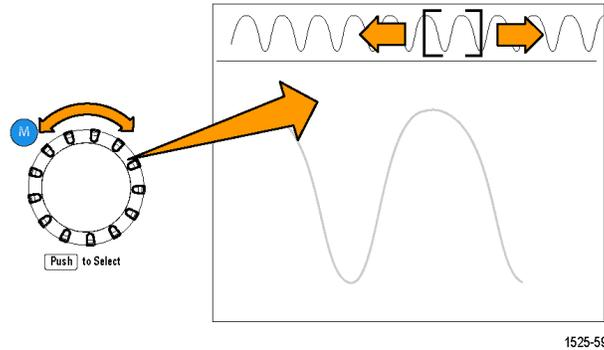
顺时针旋转 **Multipurpose**（通用）旋钮向前平移。逆时针旋转该旋钮向后平移。旋钮旋转的越多，缩放窗口平移的越快。
