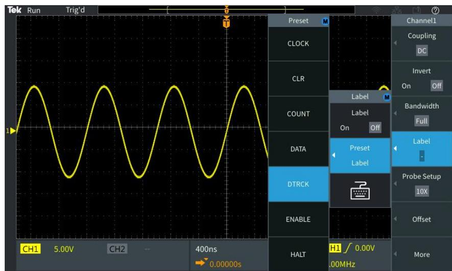
5. 旋转 **Multipurpose**（通用）旋钮以滚动预置列表来查找适合的标签。可以在插入标签后编辑标签文本。
