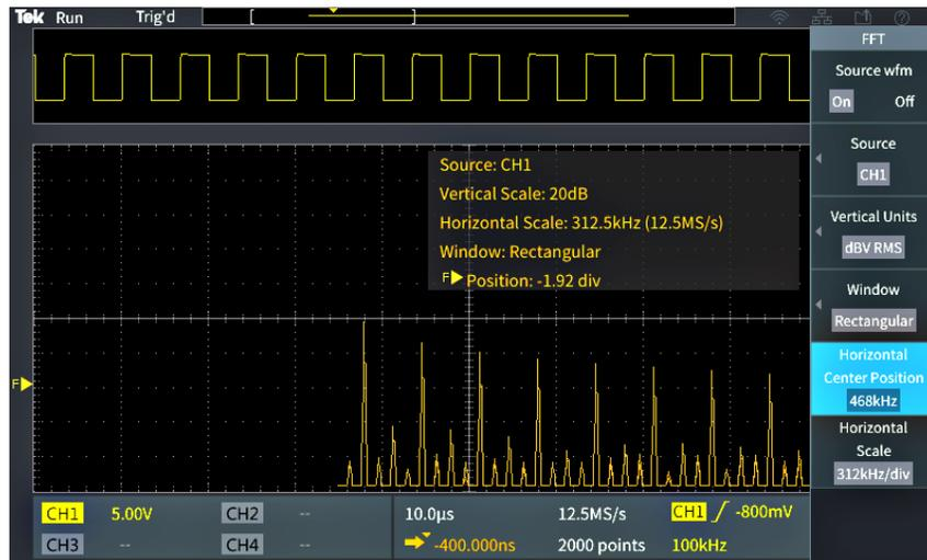
8. 按 **Horizontal Scale**（水平标度）侧面菜单按钮，并使用 **Multipurpose**（通用）旋钮以设置水平标度（每个大刻度线格频率）值。使用该功能扩展或缩小 FFT 波形以显示更多或更少细节。FFT 波形围绕中心光标扩展。
