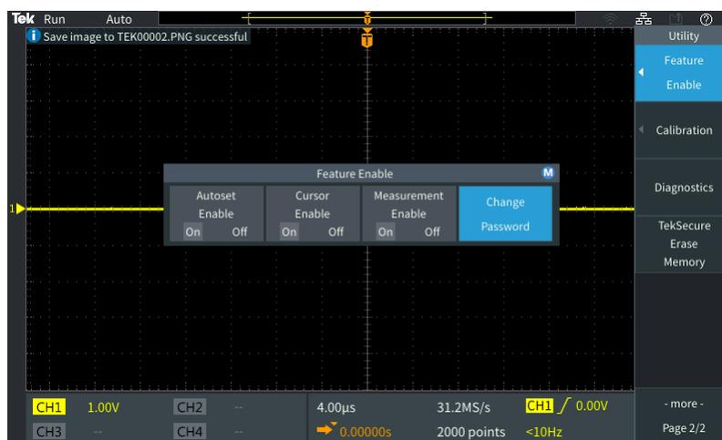
5. 使用 **Multipurpose**（通用）旋钮和侧面菜单按钮以选择字母数字并输入当前密码的字符。
