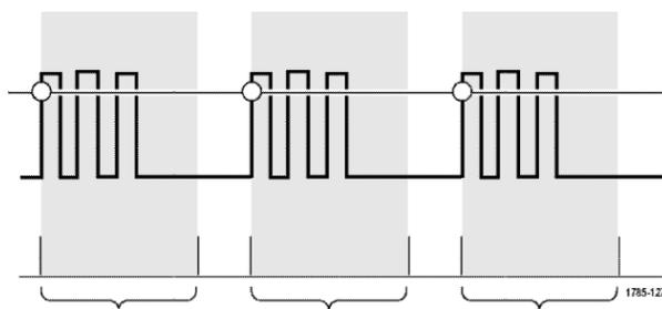
使用 **Set Holdoff to minimum**（将释抑设为最小值）将释抑值设为最小值。
