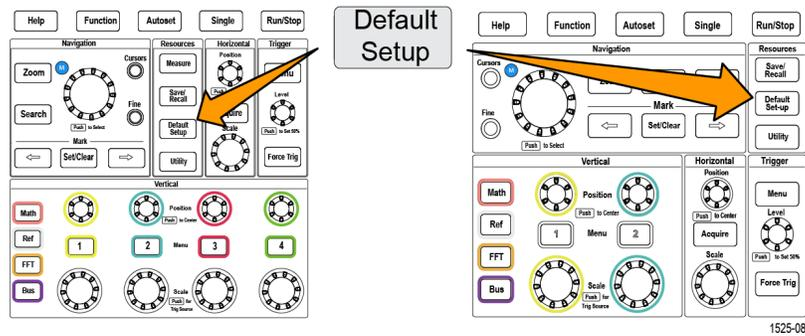
2. 如果您改变主意，请按 **Undo Default Setup**（取消默认设置）侧面菜单按钮，以将示波器恢复至您按 **Default Setup**（默认设置）之前的设置。在进行任何其他操作之前，您必须按该按钮。
