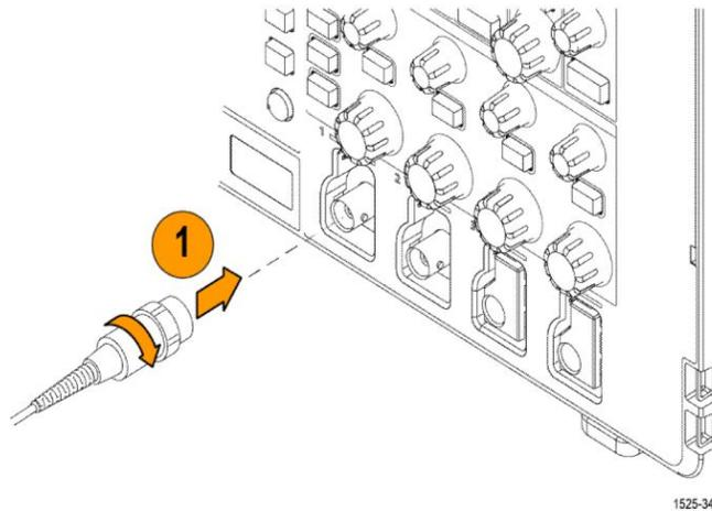
3. 将探头端部和接地导线连接至示波器的 **PROBE COMP**（探头补偿）连接器。将探头端部连接至 5 V 连接器，将接地线夹连接至接地连接器。
