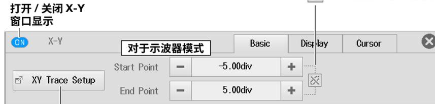
打开 / 关闭 X-Y 波形并设置源波形。
