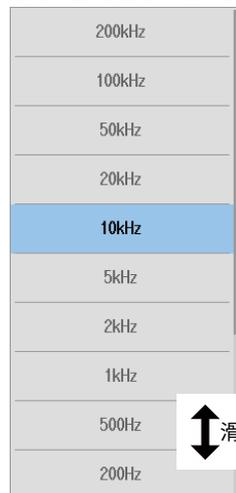
\* 不能指定高于仪器采样率的频率 (主通道采样率)。脉冲速率必须设置成让仪器采样率是脉冲速率的整数倍。根据脉冲速率和仪器采样率的组合, 可能无法使用选择的脉冲速率。
