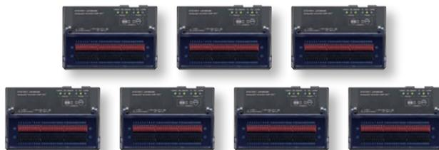
如果是电压·温度单元 U8552×4 + 无线电压·温度单元 LR8532×7，则可支持共 330 通道的测量。
